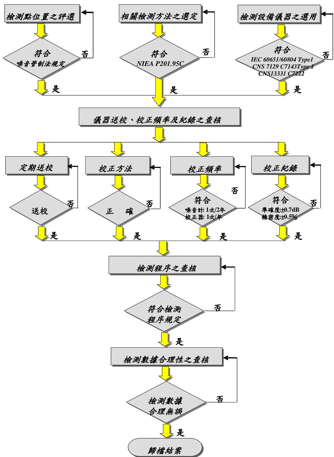
圖 1.5-2 噪音檢測品保／品管作業流程
