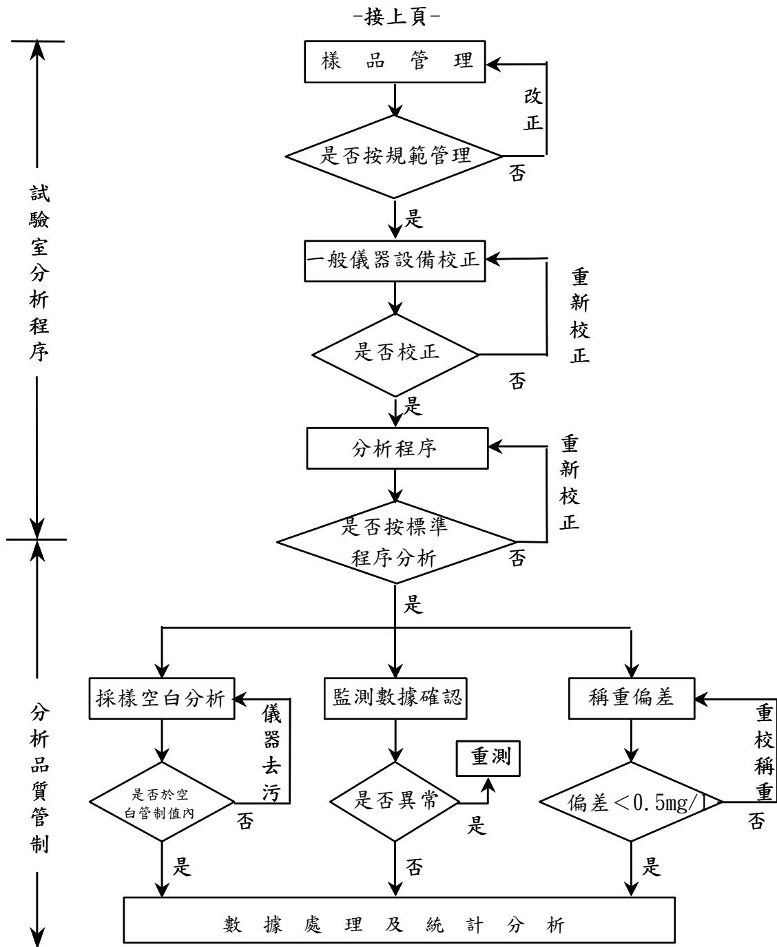
圖 1.5-1 空氣品質檢測品保／品管作業流程 (2/2)
