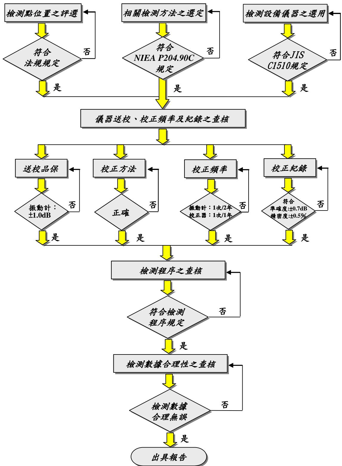
圖 1.5-3 振動檢測品保／品管作業流程
