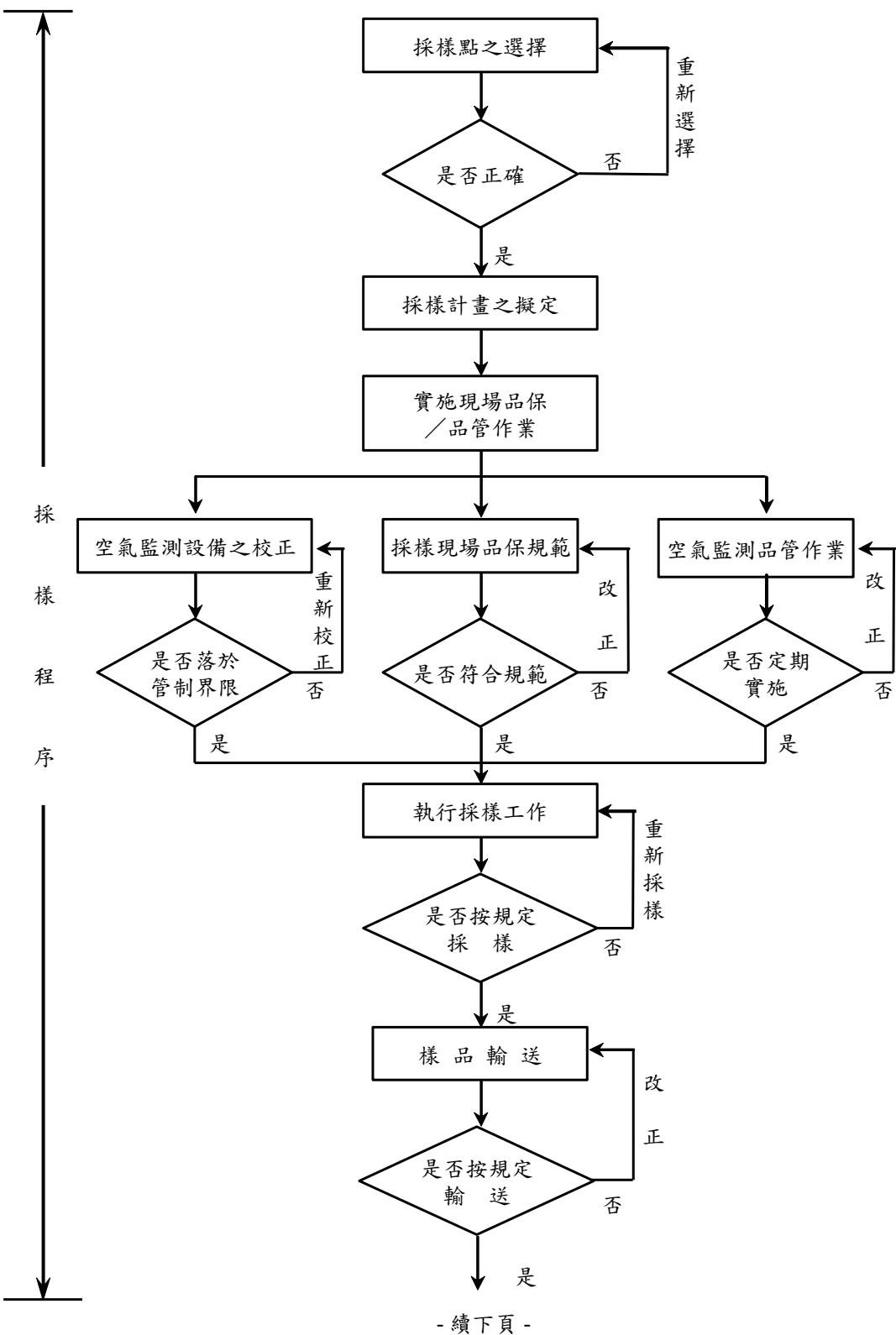
圖 1.5-1 空氣品質檢測品保／品管作業流程 (1/2)
