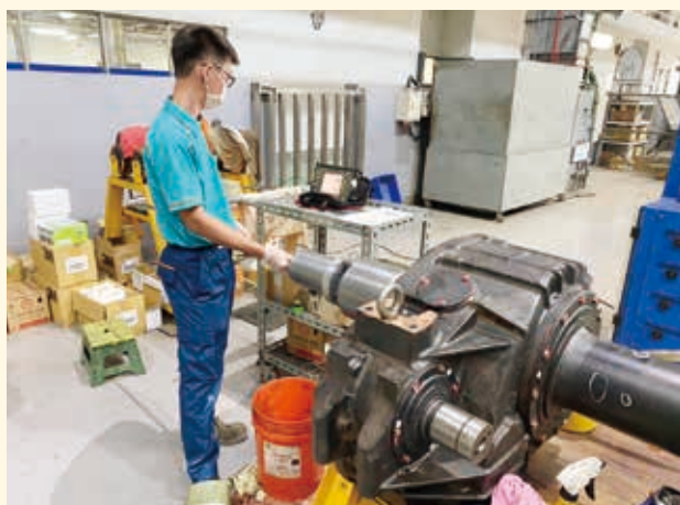
車軸超音波檢測 Shaft ultrasonic inspection
